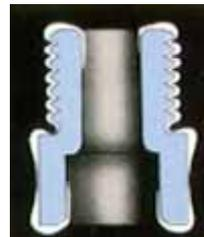
**Le dépôt** du procédé Kanigen® est une combinaison nickel – phosphore qui contient typiquement 88 à 91% de nickel et 9 à 12 % de phosphore. Le phosphore augmente de façon importante la résistance à la corrosion.
