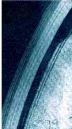
*Épaisseur 150  $\mu\text{m}$ , alternance des couches pauvre et riche en phosphore.*
